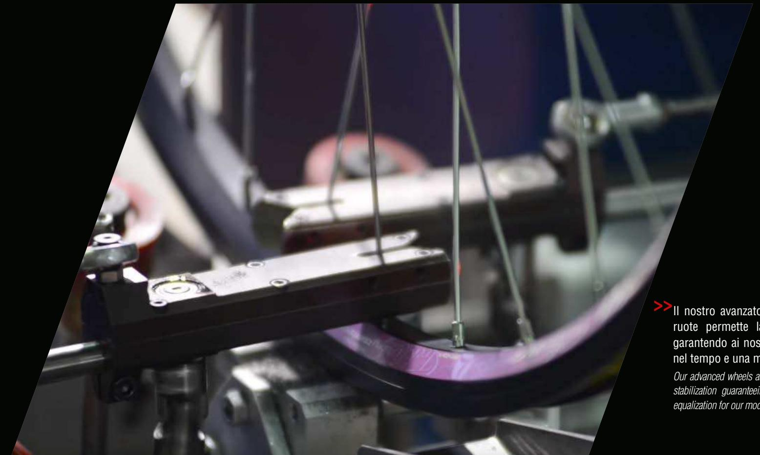
>> Il nostro avanzato impianto di assemblaggio ruote permette la stabilizzazione dei raggi garantendo ai nostri modelli maggiore durata nel tempo e una migliore qualità.
